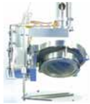
この GLAD はサンプルの回転に加えてチルト機構付
